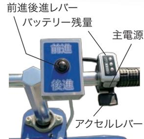
運転操作スイッチをハンドル部に集約、足踏み式のように誤って始動させる心配がありません。無段階スピード調節で前進後進の移動ができます。
